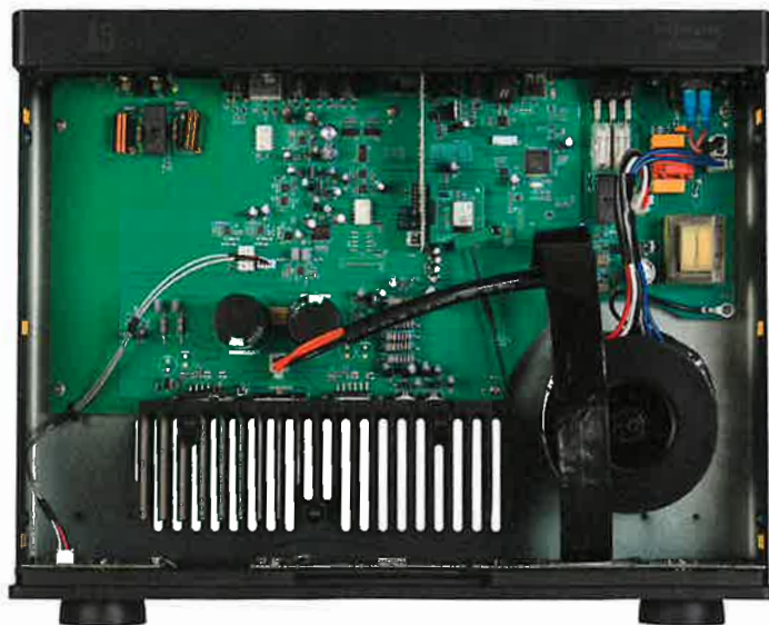
Hier ist die grundsätzliche Arcam-Topologie mit elementarer Stromversorgung und kurzen Signalwegen gut zu erkennen.
