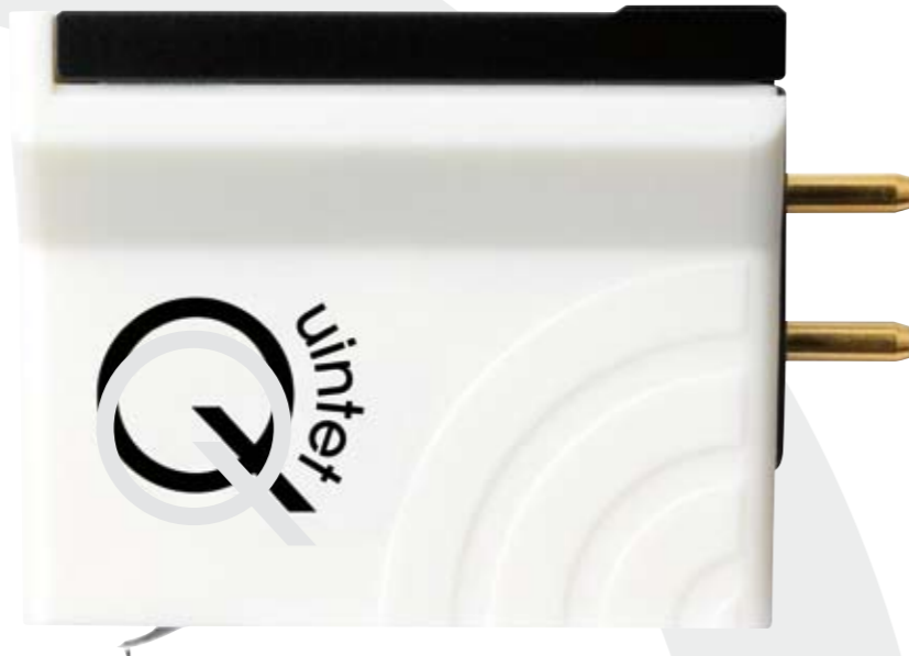
MONOMAN: Das weiße Quintet liefert rechtem und linkem Kanal identische Signale. Tiefenschrift-Anteile und Störgeräusche in vertikaler Auslenkung ignoriert es bauartbedingt. Monoplaten profitieren davon mit druckvollem, dynamischem Klang.
