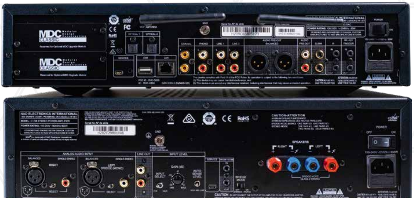
Sowohl Preamp-DAC als auch Endstufe sind anschlusstechnisch bestens ausgestattet und verarbeitet. Beim S 298 lässt sich außerdem die Eingangsempfindlichkeit einstellen, bei welcher das Gerät aus dem Standby gerufen werden soll
