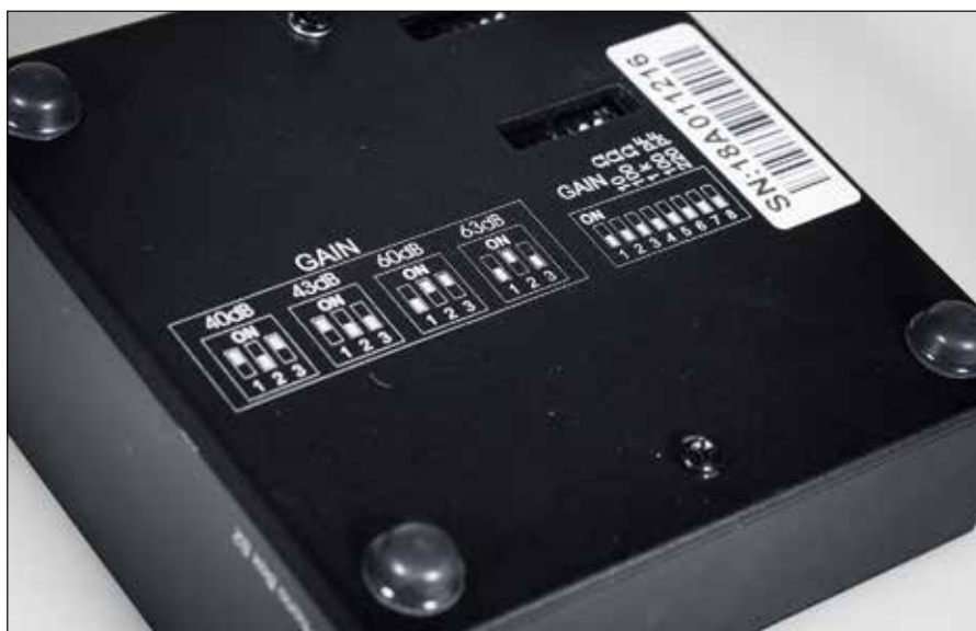
Die Dip-Switches zur Konfiguration der Verstärker-Settings sind unauffällig an der Unterseite des Gehäuses verbaut
