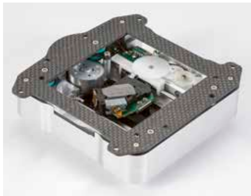
Von unten erkennt man den leichten, steifen Carbonrahmen, auf dem das solide eingefasste Laufwerk schwingend gelagert ist.
