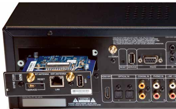
Das bidirektionale MDC2-Streaming-Modul (BluOS) kostet 600 Euro und macht den üppig ausgestatteten NAD-Amp zum Streamer.
