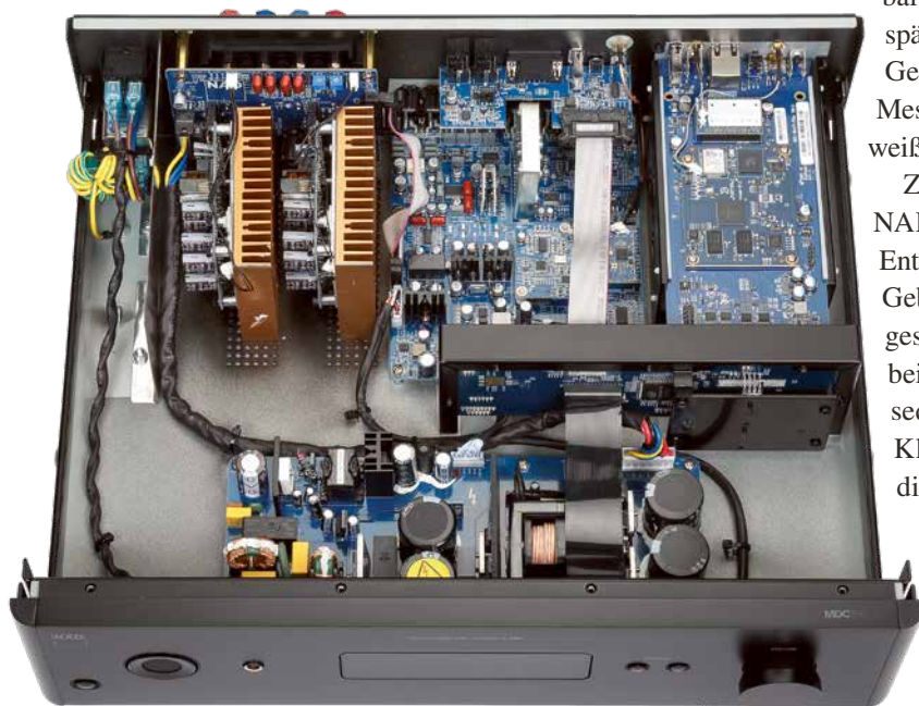
Die Hypex nCore-Endstufen versorgen den NAD mit mächtig Dampf. Breitbandig ist er trotzdem – ungewöhnlich für ein modernes Class D-Konzept.
